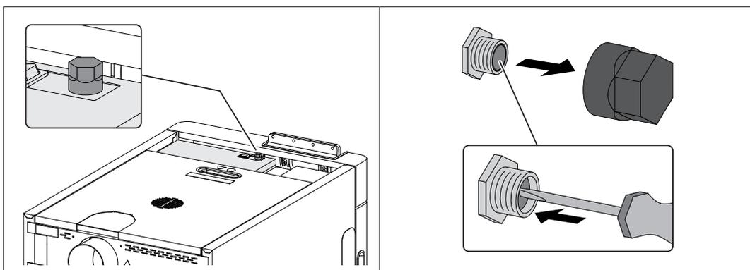
Dès que la température baisse en dessous de 75 °C environ, il est possible de déverrouiller mécaniquement le STB.
