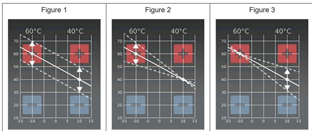
La courbe de chauffe peut être ajustée en fonction de la situation en appuyant sur « + » ou « - » à une température extérieure de +/-10 °C.
