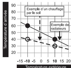
La courbe de chauffe du circuit de chauffage permet de calculer une température de départ, en fonction de la température extérieure et avec les deux paramètres réglables « température de départ avec température extérieure de  $-10\text{ °C}$  » et « température de départ avec température extérieure de  $+10\text{ °C}$  ».
