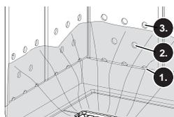
**Recommandation :** Ne pas enlever les cendres de la chambre de combustion à chaque démarrage, mais uniquement quand la rangée de trous centrale (2) des tabliers de la chambre de combustion n'est plus visible. Une couche de cendres homogène permet de protéger la chambre de combustion et de faciliter le démarrage.
