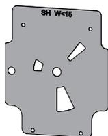
Pour la combustion optimale de combustibles contenant moins de 15 % d'eau, l'arrivée d'air doit être ajustée. Pour cela, les sections d'arrivée d'air sont optimisées au moyen d'une tôle de réduction du débit d'air (réf. Fröling T244132). Les étapes suivantes illustrent le montage.
