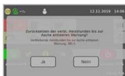
**REMARQUE !** Après l'ouverture de la porte isolante, le message « Réinitialiser les heures de chauffage restant jusqu'à l'avertissement Vider cendres » s'affiche à l'écran de la chaudière. En confirmant avec « OUI », le compteur est réinitialisé sur la valeur prédéfinie.
