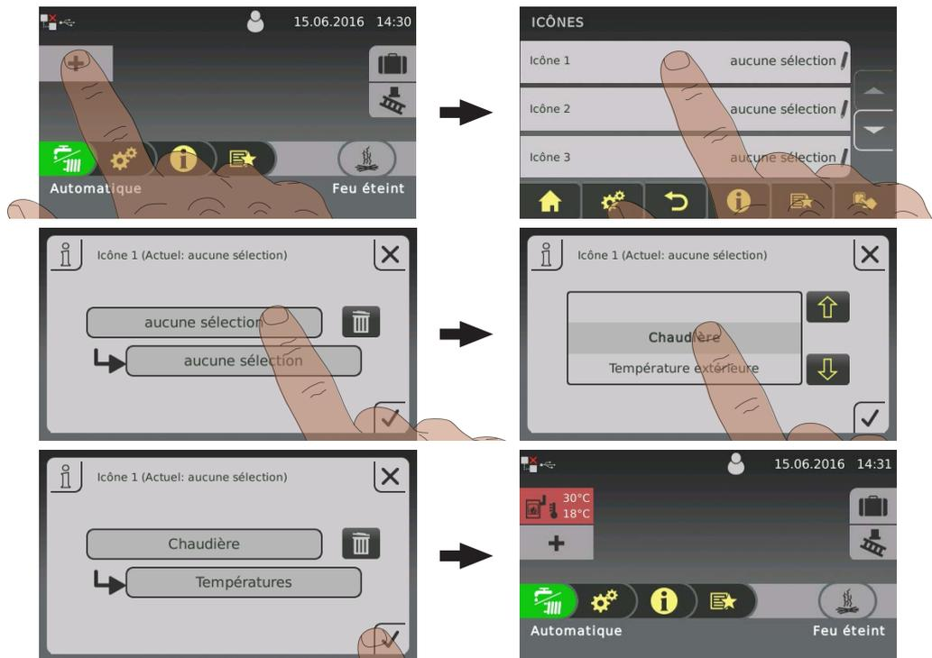
En cas d'utilisation de plus de deux sondes d'accumulateur, un affichage d'informations est possible avec les températures d'accumulateur conformément au nombre de sondes. L'illustration a lieu via un affichage d'informations déroulant sur deux surfaces.
